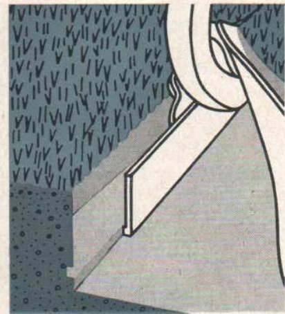
18. Märket från bakre landsidans klack skall ligga någon cm ovan fårans botten. Observera att plogkroppen sjunkit tillbaka i fåran när man stannat traktorn.
